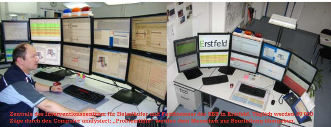
Zentrale des Interventionszentrum für Heissläufer und Festbremsen der SBB in Erstfeld. Täglich werden 20'000 Züge durch den Computer analysiert; „Problemfälle“ werden dem Menschen zur Beurteilung übergeben.
